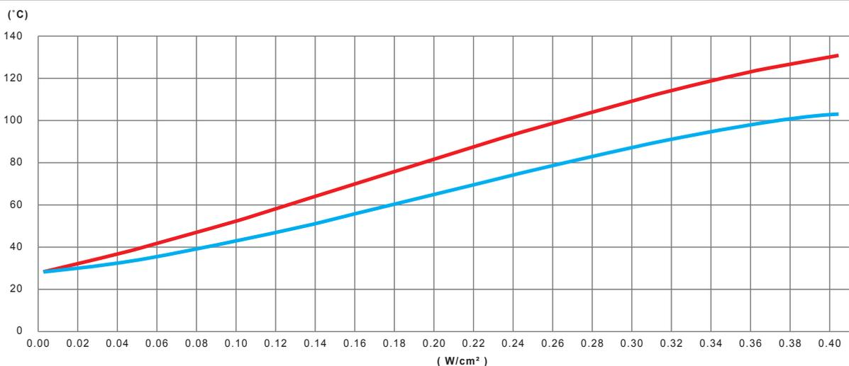
Variazione, in funzione della potenza in W/cm<sup>2</sup> del nastro riscaldante in silicone, della temperatura della parete di un tubo in PVC riempito con acqua non circolante, non isolato termicamente.
