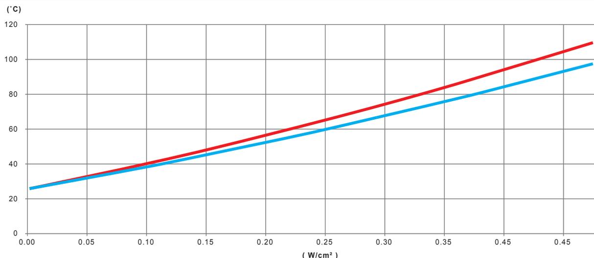
Variation, in function of the power in  $W/cm^2$  of the silicone heating tape, of the wall temperature of a **tubo di acciaio inossidabile, riempito con acqua non circolante, isolato termicamente da 20mm di schiuma PVC-NBR.**
