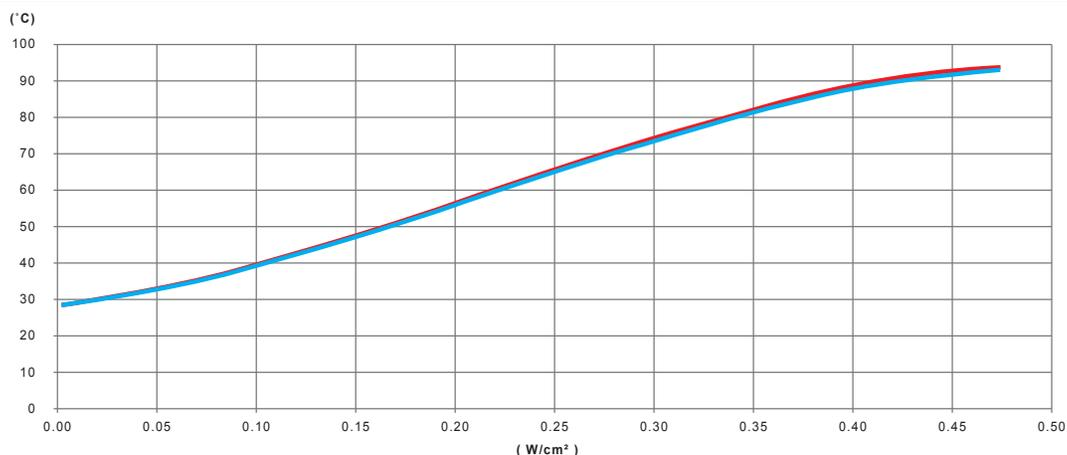
Variation, in function of the power in W/cm<sup>2</sup> of the silicone heating tape, of the temperature of the wall of a **tubo di acciaio zincato riempito con acqua non circolante, isolato termicamente da 20mm di schiuma PVC-NBR.**
