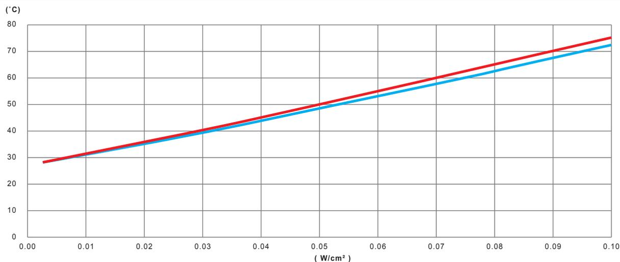
Variazione, in funzione della potenza in W/cm<sup>2</sup> del nastro riscaldante in silicone, della temperatura della parete di un tubo di PVC vuoto, isolato termicamente da 20mm di schiuma PVC-NBR
