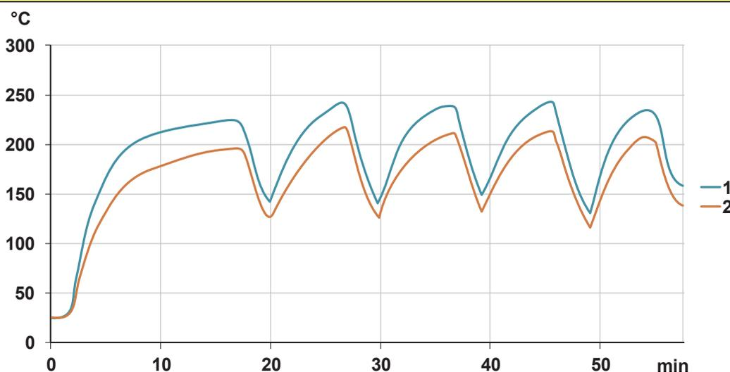
Misurazione della temperatura effettuata su un nastro di silicone di 200mm di larghezza montato su un fusto da 55 galloni (200 litri). Potenza 2250W (0.75W/cm<sup>2</sup>), controller PID con sensore posizionato al centro del serbatoio vuoto. Temperatura superficiale limitata a 190°C da un termostato a disco.
