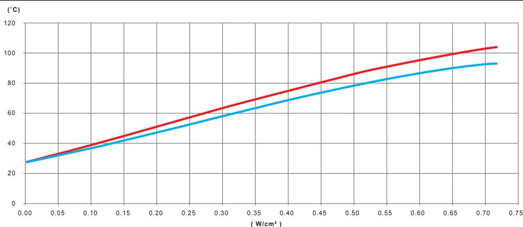
Variation, in function of the power in W/cm<sup>2</sup> of the silicone heating tape, of the temperature of the wall of a **tubo di acciaio zincato riempito con acqua non circolante, non isolato termicamente**
