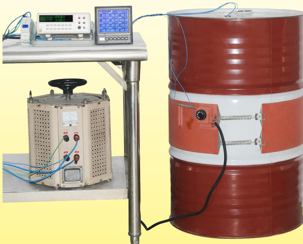
Variazione della temperatura rispetto al tempo di un fusto metallico da 220 litri, **riempito d'acqua**, riscaldato da un nastro riscaldante in silicone largo 200mm, senza isolamento termico, potenza **2250 W** (carico superficiale di **0.75 W/cm<sup>2</sup>**).
